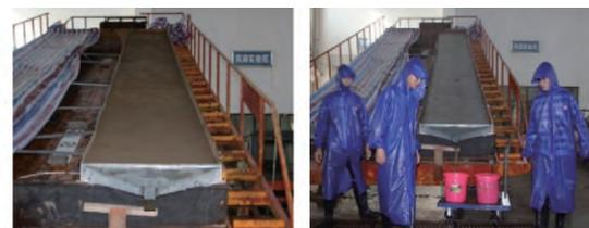
(a) 实验土槽 (b) 径流泥沙采集
