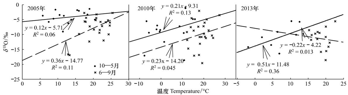
图4 降雨  $\delta^{18}\text{O}$  与温度的关系
