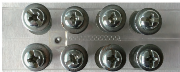
图2 迷宫流道灌水器及有机玻璃试验样件
