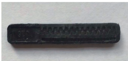
图2 迷宫流道灌水器及有机玻璃试验样件
