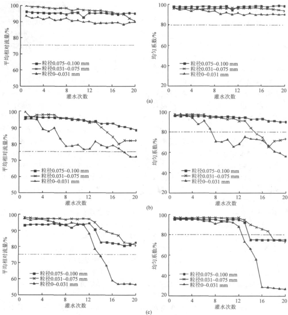
图4 粒径、含沙量对滴头流量及均匀系数的影响
