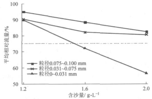
图3 试验期间滴头流量随含沙量变化曲线
