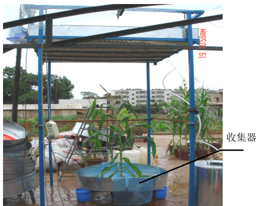
图 1 降雨淋洗试验装置
