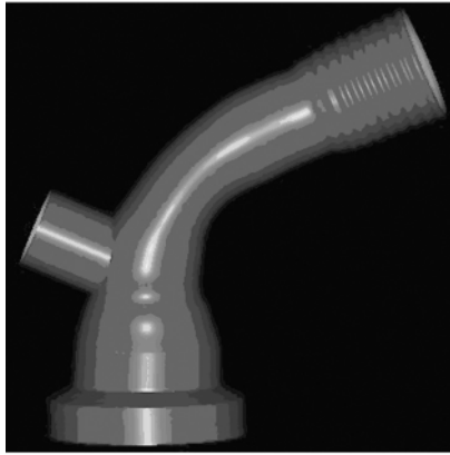
图 8 喷头内流道的重构曲面
