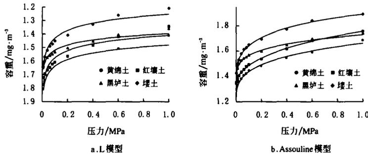
图1 两种模型对4种土壤的拟合曲线
