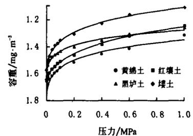
图2 改进模型对4种土壤的拟合曲线
