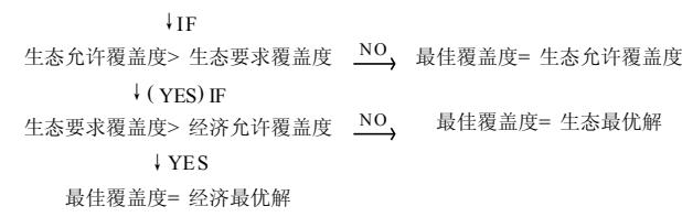
图 1 最佳覆盖度判断流程图
