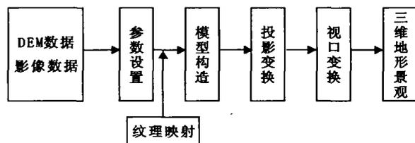
图 1 用 OpenGL 构造三维地形景观流程图
