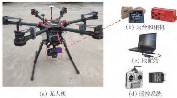
图2 无人机多光谱影像采集系统
