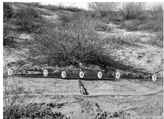
注:图中7个数字标识分别为试验中的不同采样点;①为灌丛沙堆上坡位边缘;②为上坡位边缘与灌丛主根之间 1/2 处;③为上坡位边缘与灌丛主根之间 3/4 处;④为灌丛主根位置;⑤为下坡位边缘与灌丛主根之间 1/2 处;⑥为下坡位边缘与灌丛主根之间 3/4 处;⑦为下坡位边缘。下同。
