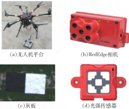
图 3 无人机多光谱影像采集系统 Fig. 3 UAV multispectral images acquisition system
